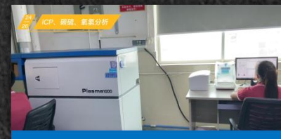
Phân tích ICP cacbon- lưu huỳnh, hydro-oxi
