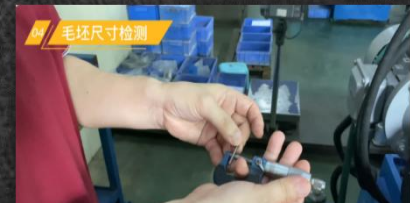
Kiểm tra kích thước phôi thô
