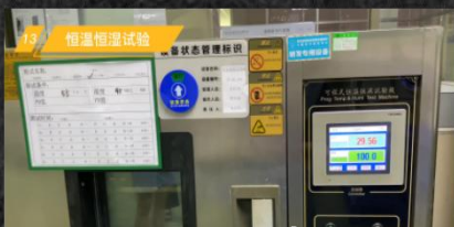
Thử nghiệm ổn định nhiệt độ và độ ẩm
