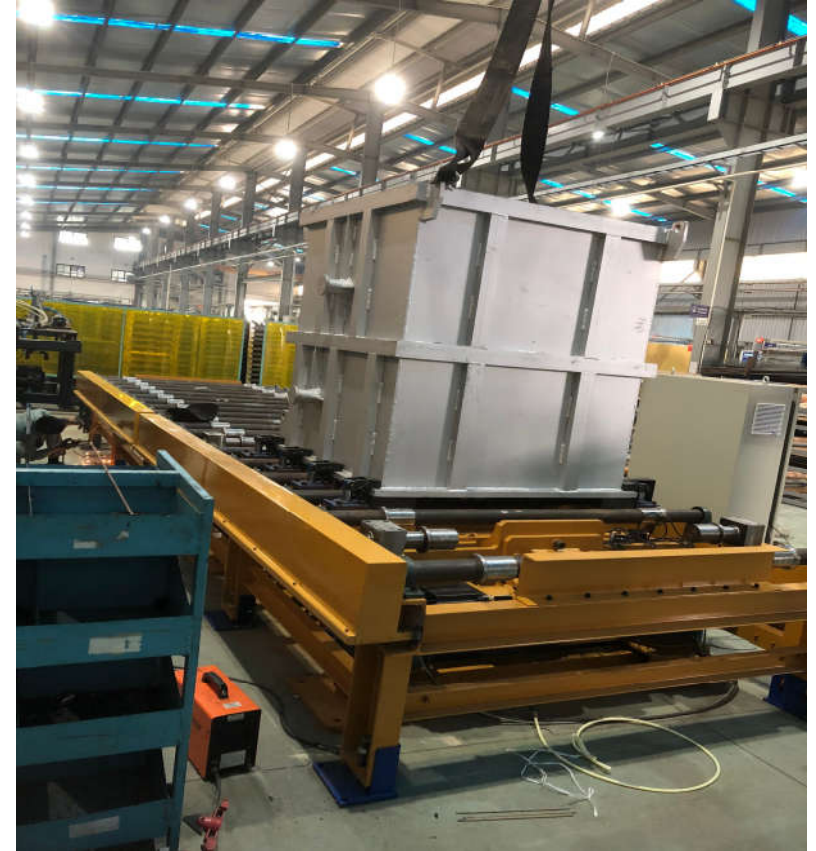
HỆ THỐNG BÀN RUNG BĂNG TẢI CON LĂN ROLLER CONVEYOR BELT SYSTEM
